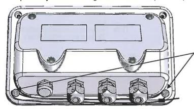
Plomb et fil perlé sur 2 vis percées Lead and sealing wire on 2 pierced screws
