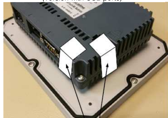
Étiquettes de scellement protégeant l'accès aux ports USB Sealing stickers securing access to USB ports
